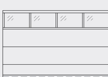
Modèle 709 – 3 sections 707 (panneaux sandwich en acier) avec socle découpé. La section supérieure est une section vitrée 909 (structure en profilés d'aluminium).
