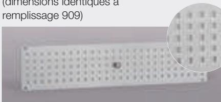
Grille d'aération alu avec bouton de commande trous carrés de 7 mm, 400 x 90 mm fermeture de l'intérieur, Section d'aération 63,7 cm<sup>2</sup>
