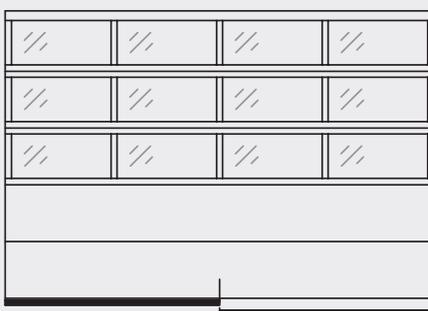
Modèle 709 – socle 707 (2 sections panneau sandwich en acier) et 3 sections supérieures 909 (structure en profilés d'aluminium) comptant 4 champs.
