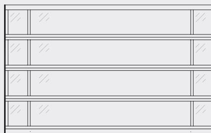
Structure en profilés d'aluminium, 4 sections à division asymétrique. Remplissage constitué de double vitrage acrylique.
