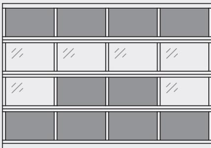
Structure en profilés d'aluminium 909, 4 sections et 4 champs, toutes les sections sont garnies d'un remplissage en tôle d'aluminium stucco à double paroi ou d'un double vitrage acrylique, conformément aux spécifications du client.
