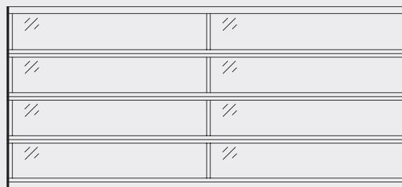
Structure en profilés d'aluminium, 4 sections présentant une largeur maximale de 3800 mm par champ. Remplissage constitué de double vitrage acrylique (selon le type de vitrage, la largeur maximale de champ peut varier).
