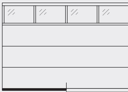
Modèle 709 -3 sections 707 (panneaux sandwich en acier), section supérieure vitrée 909 (structure en profilés d'aluminium).
