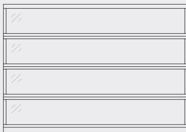
Structure à profilés horizontaux en aluminium, 4 sections présentant une largeur maximale de 3800 mm. Remplissage constitué de double vitrage acrylique (selon le type de vitrage, la largeur maximale peut varier).
